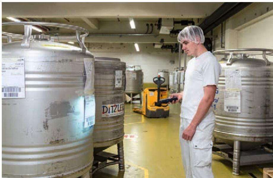
Pour éviter toute erreur, chaque composant est scanné avant d'être ajouté au produit.
